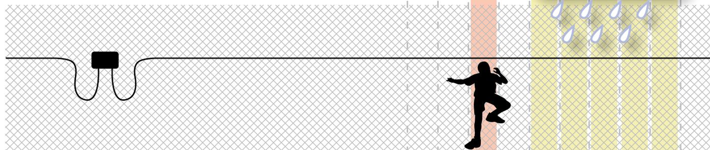
Quando un bersaglio entra in contatto con la recinzione il segnale ricevuto viene campionato per creare una "impronta" descrittiva dell'impulso riflesso. Il Processamento Digitale del Segnale (DSP) misura la posizione e la forma dell'impulso. Il microprocessore è in grado di differenziare la forma di una risposta da un Punto di impatto (tentativo di taglio o scavalamento) rispetto alla forma della risposta causata da un disturbo distribuito (pioggia, vento, traffico di veicoli).
